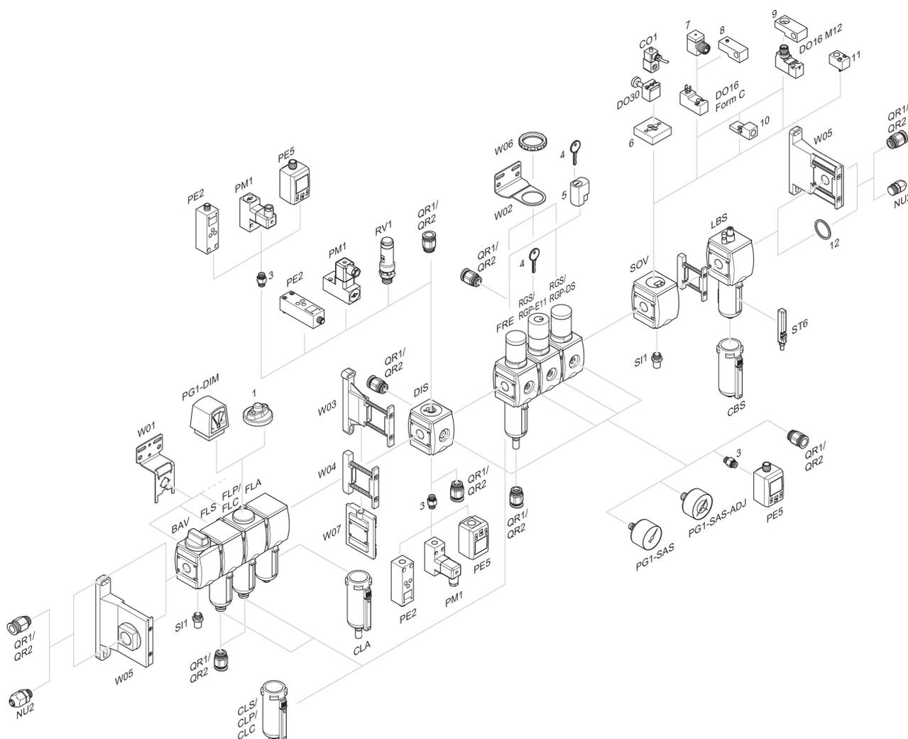
1 = Indicador de sujeira 3 = Niple duplo 4 = Chave para fechamento E11 5 = fechadura de embutir 6 = Placa adaptadora DO30 7 = Adaptador, Série CON-VP 8 = Auxiliar de montagem DO16, formato C 9 = Auxiliar de montagem DO16, M12 10 = Adaptador de ar de comando externo 11 = Adaptador de acionamento pneumático 12 = Anel de vedação
