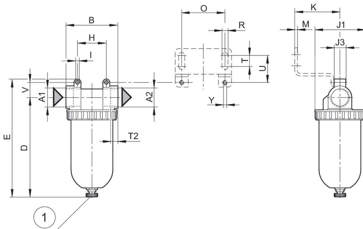
1) Manueller bzw. halbautomatischer Kondensatablass
