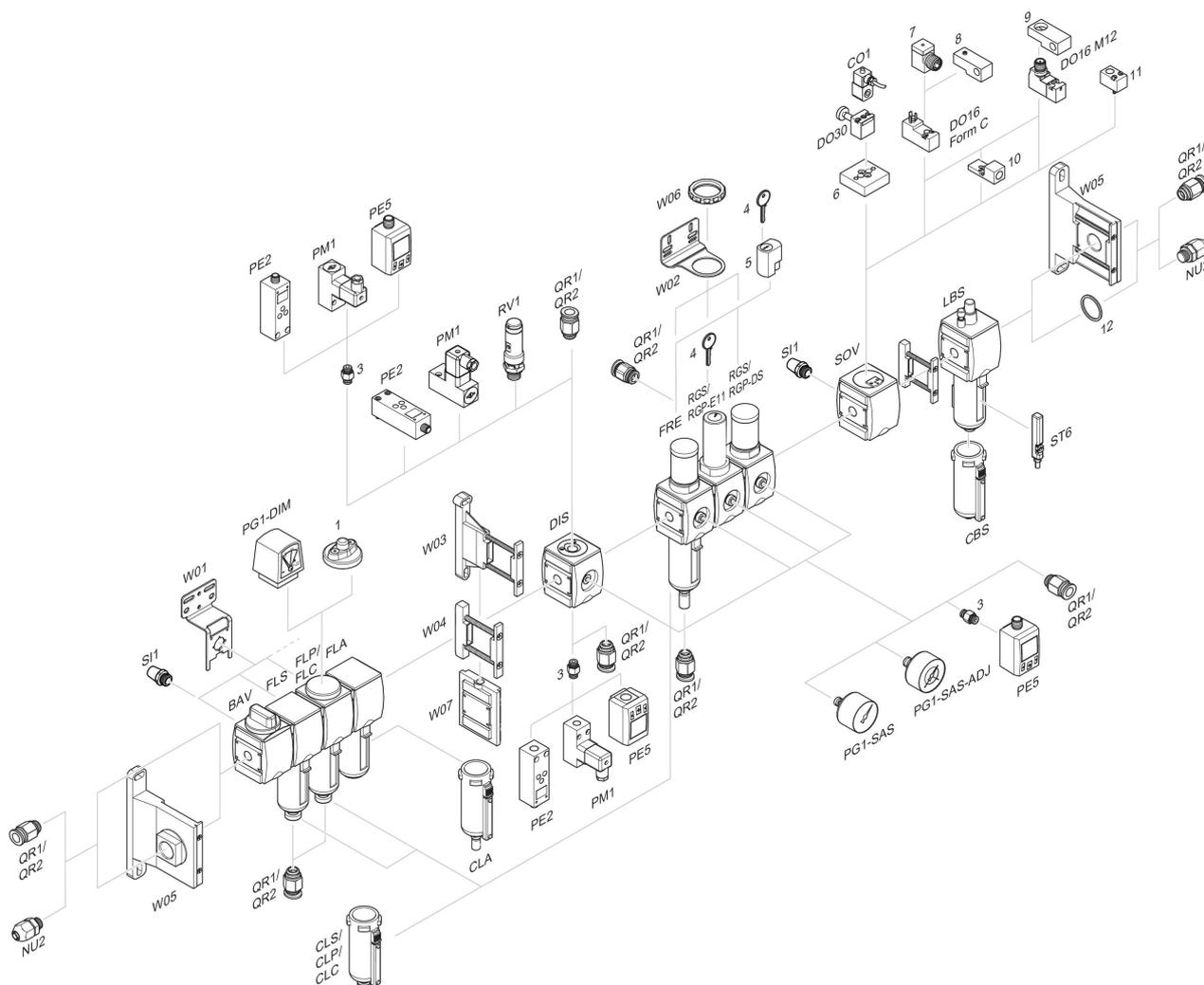
1 = 汚れ表示 3 = ダブルニップル 4 = E11 ロック用キー 5 = 彫り込み型箱継 6 = アダプタープレート DO30 7 = アダプター, シリーズ CON-VP 8 = 取付け器具 DO16, 型C 9 = 取付け器具 DO16, M12 10 = 外部パイロットエアに適しています 11 = アダプター 空圧作動 12 = 封リング
