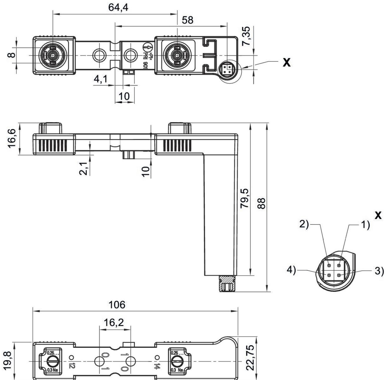
ocupación de pines: Pin 1: lado del imán 14 Pin 2: lado del imán 12 Pin 3: contacto de puesta a tierra Pin 4: 0 V
