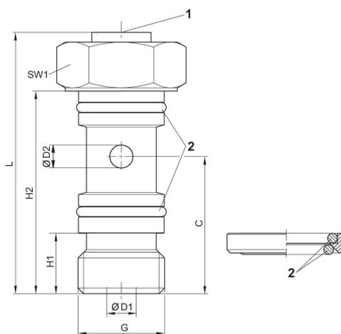
1) Schlitz in Drosselschraube 1 mm
