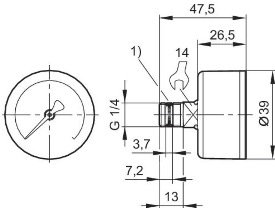
1) montierte Dichtung
