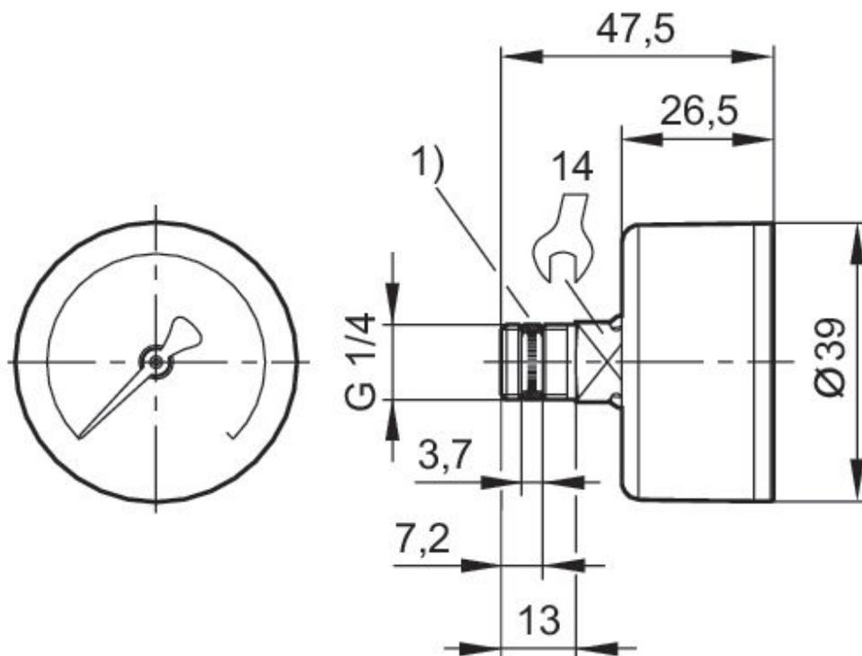
1) montierte Dichtung
