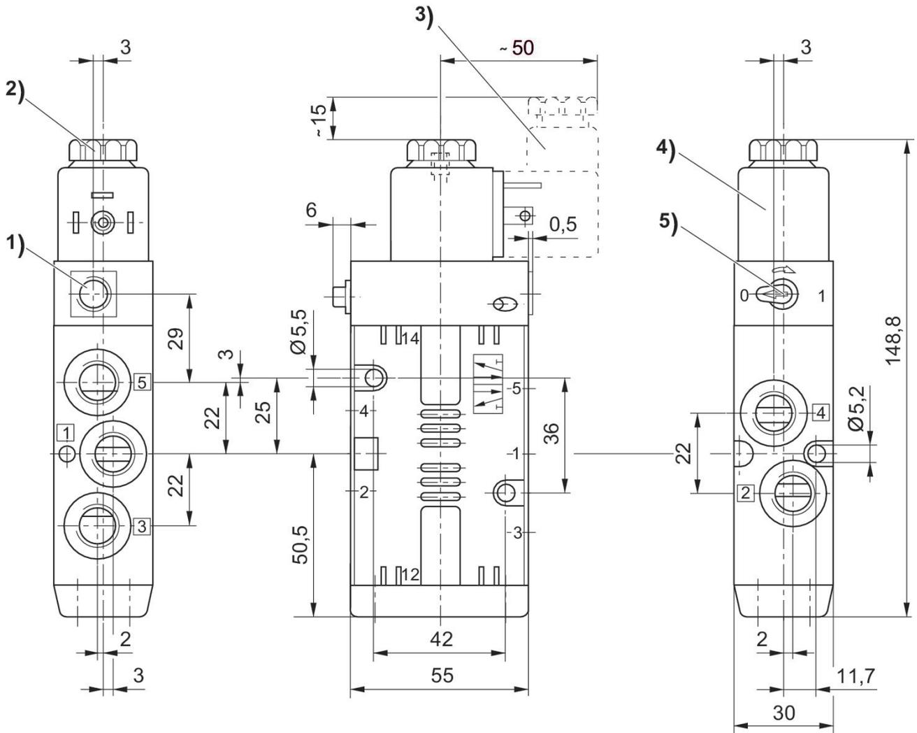
1) Solo con pilotaggio separato G 1/8 2) dopo la rimozione del coperchio filettatura interna M5 3) connettore valvola
