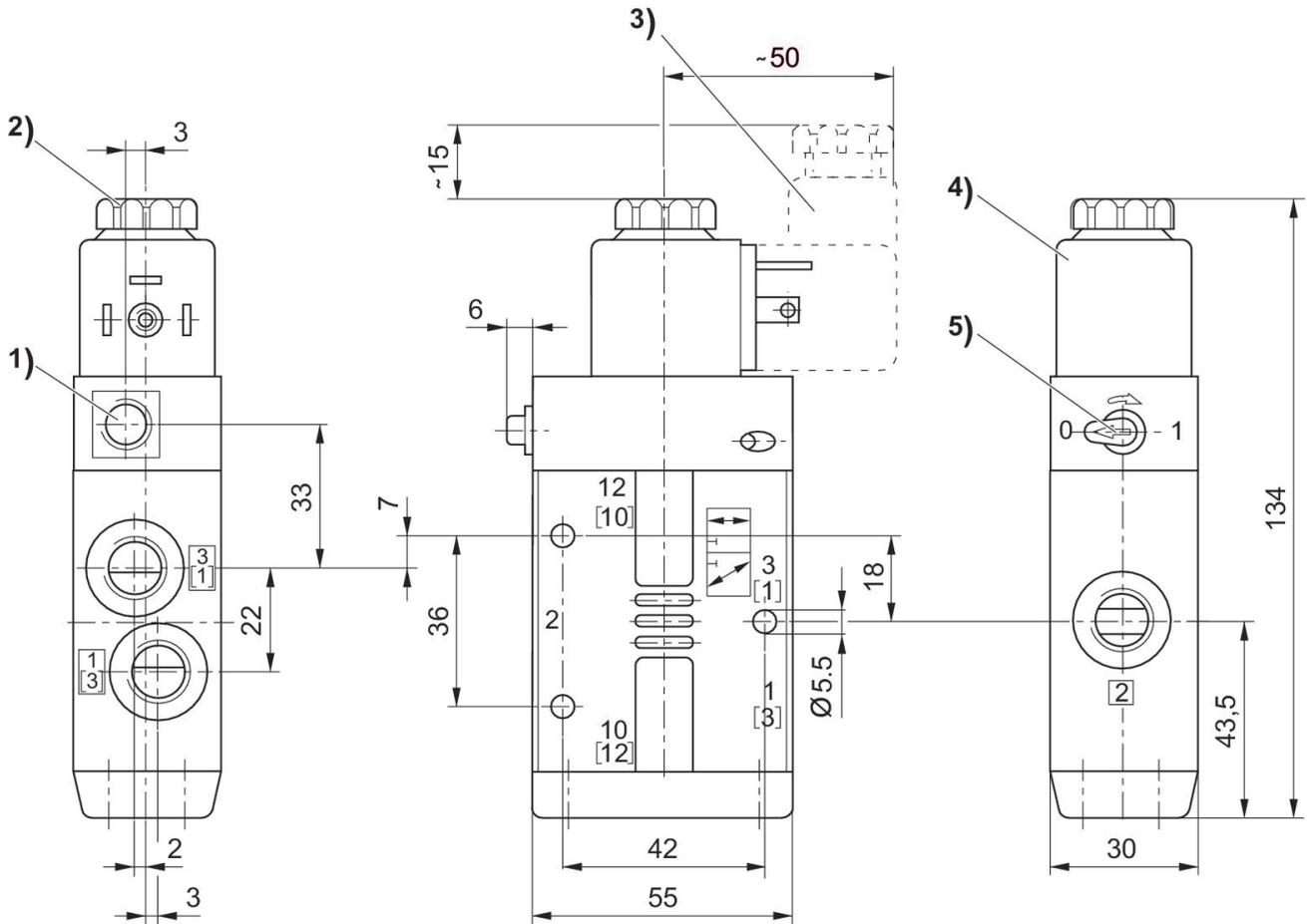
1) Nur bei separater Vorsteuerung G 1/8 2) nach Entfernen der Kappe Innengewinde M5 3) Ventilsteckverbinder 4) Spule jeweils um 45° steckbar 5) Handhilfsbetätigung
