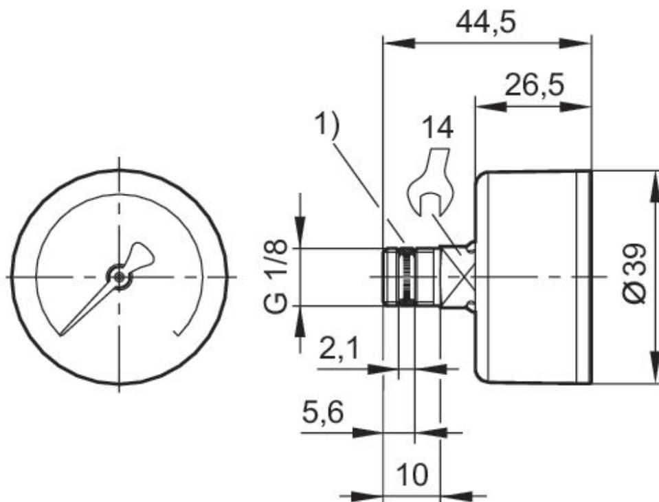
1) montierte Dichtung
