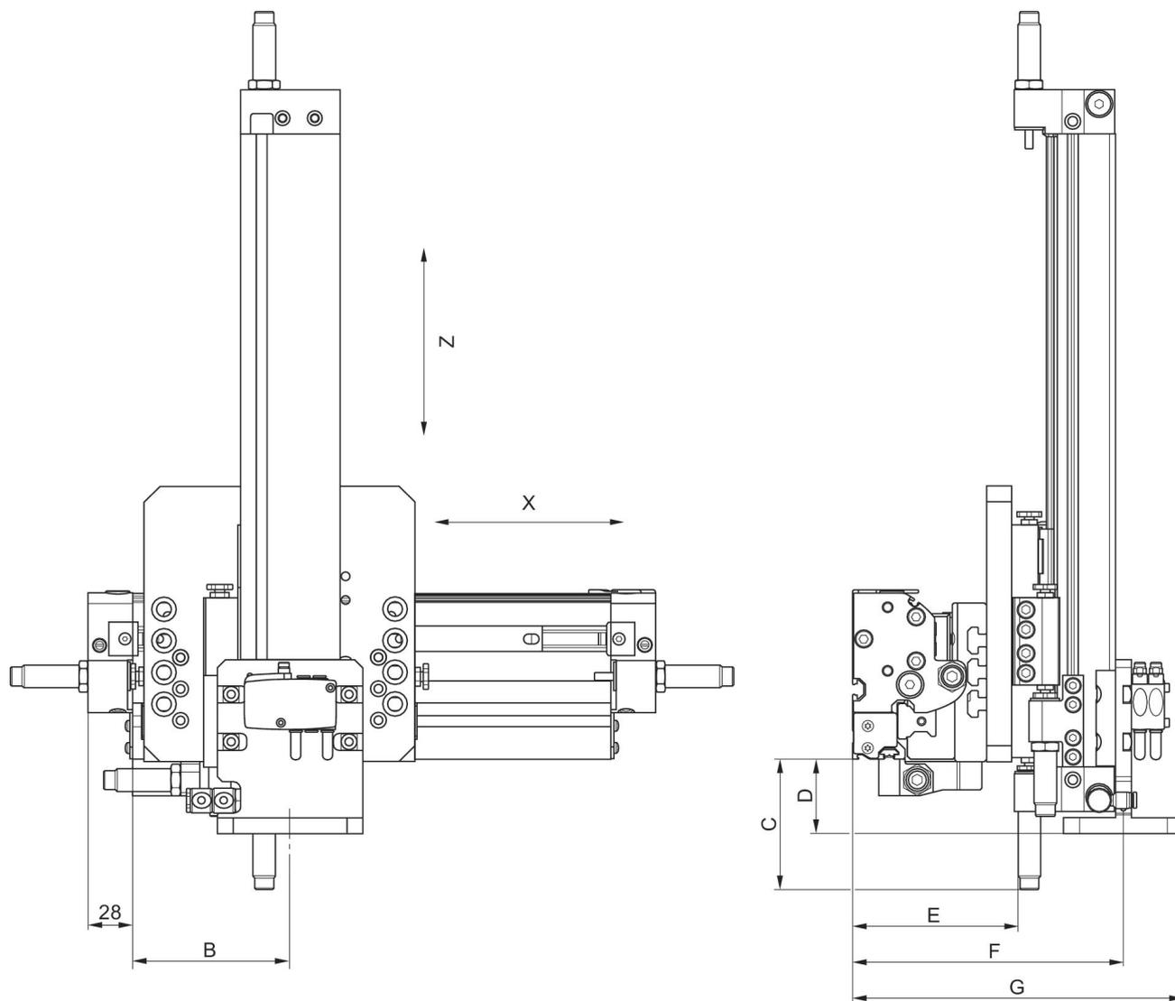
指示: シリンダの過負荷を防ぐために、次の最大速度を遵守してください。X (RTC-HD): 最大ストローク: 4300 mm 最大速度: 0.7 m/s (完全Z軸の重心の均衡がとれている場合) Z (RTC-CG): CG25の最大ストローク: 500 mm CG32の最大ストローク: 700 mm 最大速度: 1.2 m/s (最大ストロークの場合) 最大重量: 2 kg
