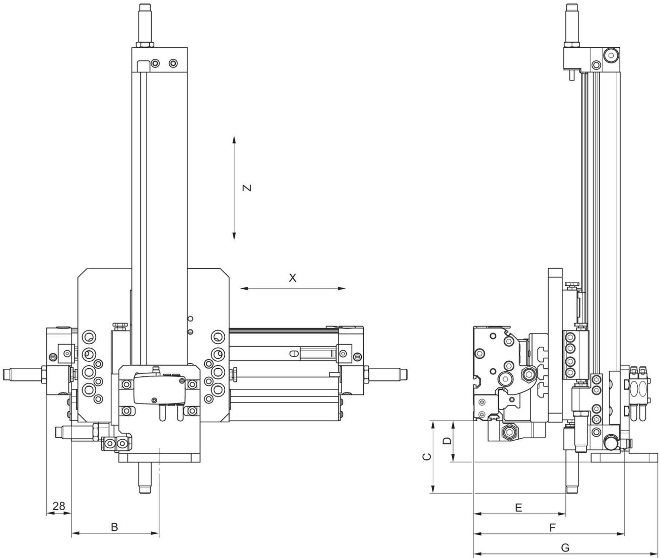
HINWEIS: Um eine Überlastung des Zylinders zu vermeiden, beachten Sie bitte die max. Geschwindigkeit wie nachfolgend angegeben. X (RTC-HD): Hub max.: 4300 mm Geschwindigkeit max.: 0,7 m/s (bei ausgewogener Schwerpunktlage der kompletten Z-Achse) Z (RTC-CG): Hub max. für CG25: 500 mm Hub max. für CG32: 700 mm Geschwindigkeit max.: 1,2 m/s (bei Hub max.) Gewicht max.: 2 kg
