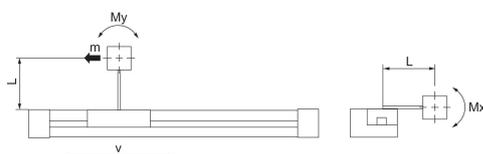
L は組立て板の中心と組立ての質量中心の距離を表します。
