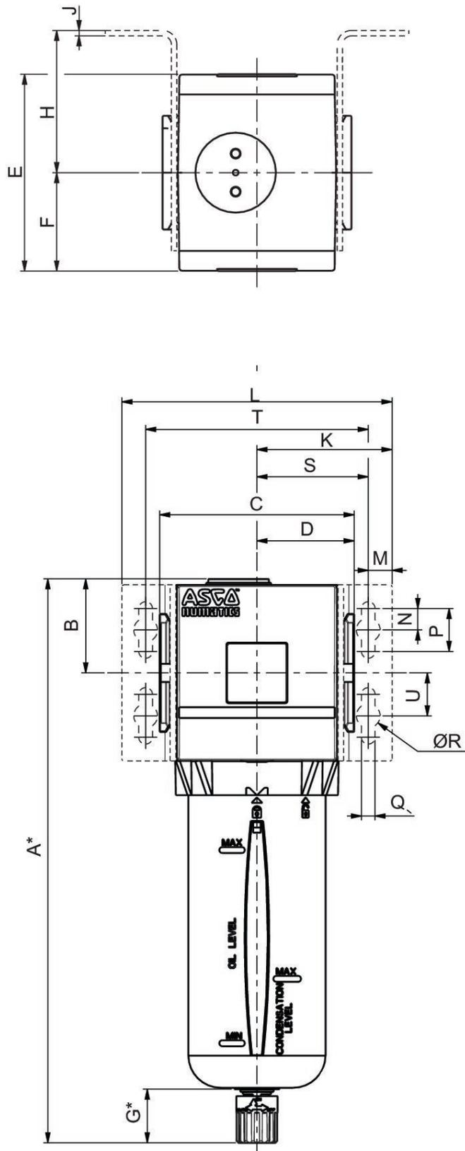
\*A dimensão varia em função da descarga indicada, no caso de uma descarga automática, é necessário acrescentar [[5 mm] adicionais à dimensão "G", o que também aumenta a dimensão "A" em mais 5 mm
