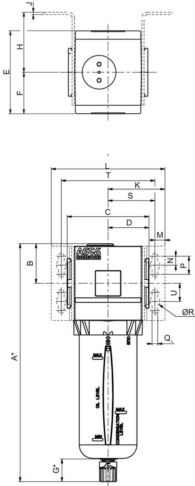
\* 表示される排出に応じて寸法が異なります, 自動排出時は、更に [[5] mm] を寸法「G」に追加する必要があり、これによって寸法「A」も同様に 5 mm 延長されます。
