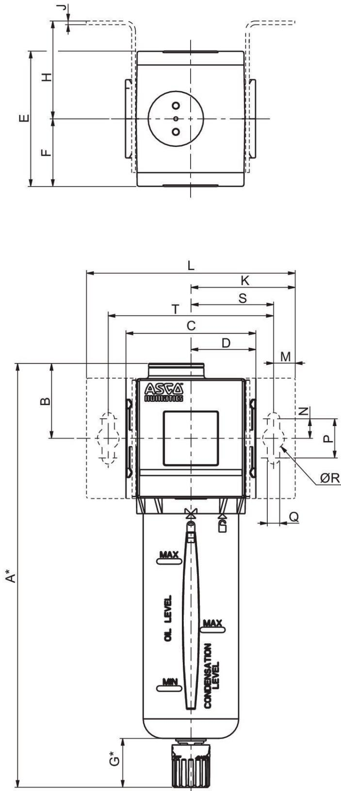
\*A dimensão varia em função da descarga indicada, no caso de uma descarga automática, é necessário acrescentar [[5] mm] adicionais à dimensão "G", o que também aumenta a dimensão "A" em mais 5 mm
