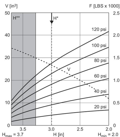
V = Volume H = Altura H\* = Altura de operação recomendada para Isolamento da vibração H\*\* = Utilização apenas após contato com a AVENTICS
