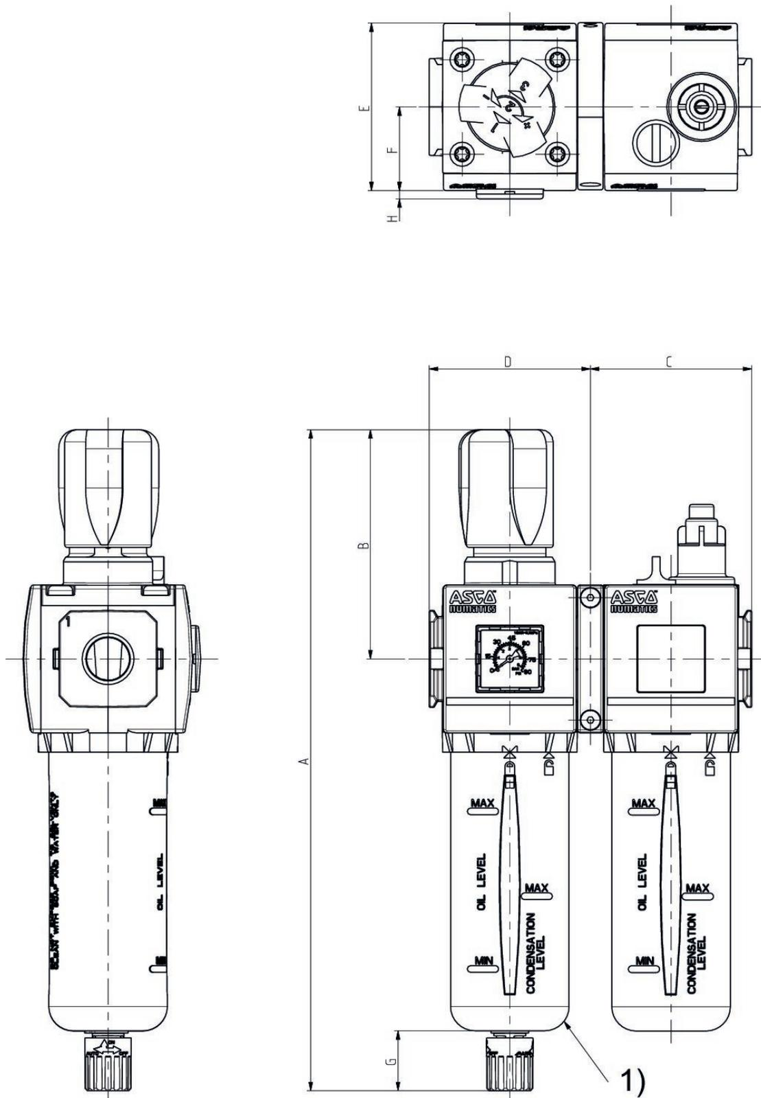
1) Pour retirer le bac, observer une distance de  $[[105]]$  mm au bord inférieur de l'évacuation du bac.
