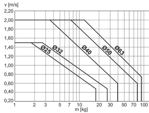
v = Kolbengeschwindigkeit [m/s] m = Dämpfbare Masse [kg]
