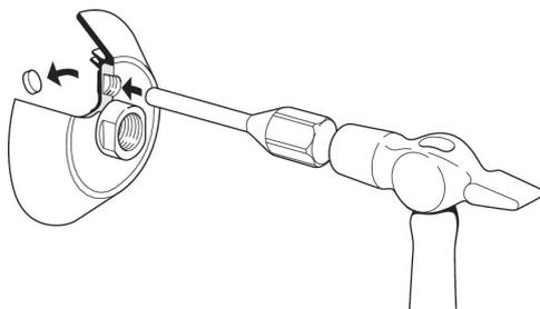
Am Gewindeanschluss der Sauggreifer Ø 100, 150, 225 und 300 kann ein Belüftungsventil angeschlossen werden. Dazu muss der Stopfen mit einem Hammer und einem Dorn herausgeschlagen werden.
