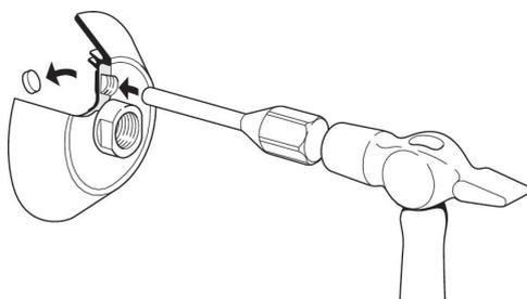
Al raccordo filettato delle ventose con Ø 100, 150, 225 e 300 può essere collegata una valvola di scarico. In questo caso è necessario estrarre il tappo con un martello e uno spinotto.
