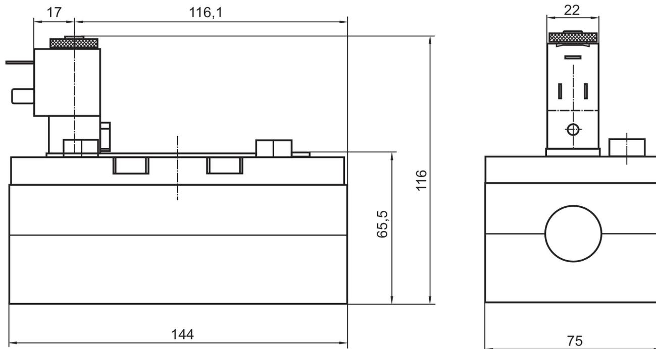
Las válvulas piloto electrónicas se pueden aflojar y girarse 180°.
