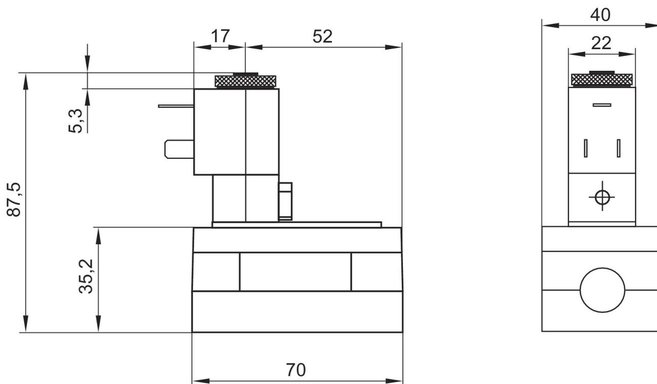
Las válvulas piloto electrónicas se pueden aflojar y girarse 180°.
