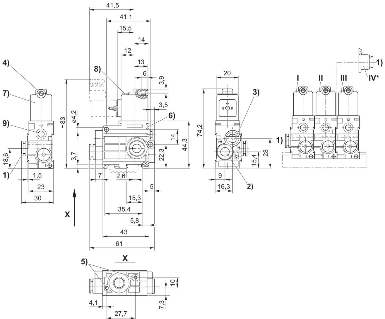
1) Anschluss 1 2) Anschluss 2 3) Anschluss 3, Abluft darf nicht gedrosselt werden 4) Kern- $\phi$  für M5 5) Sackloch 6 tief für Blechschraube 3,5 6) Befestigungsmöglichkeit für Bezeichnungsschild 7) Spule um 180° drehbar 8) LED 9) Anschluss 12 \* Luft-Anschlussmodul (Pos. IV) montiert an Verkettungsventil (Pos. II) erlaubt zusätzliche Lufteinspeisung von der rechten Seite. Endventil (Pos. III) entfällt.
