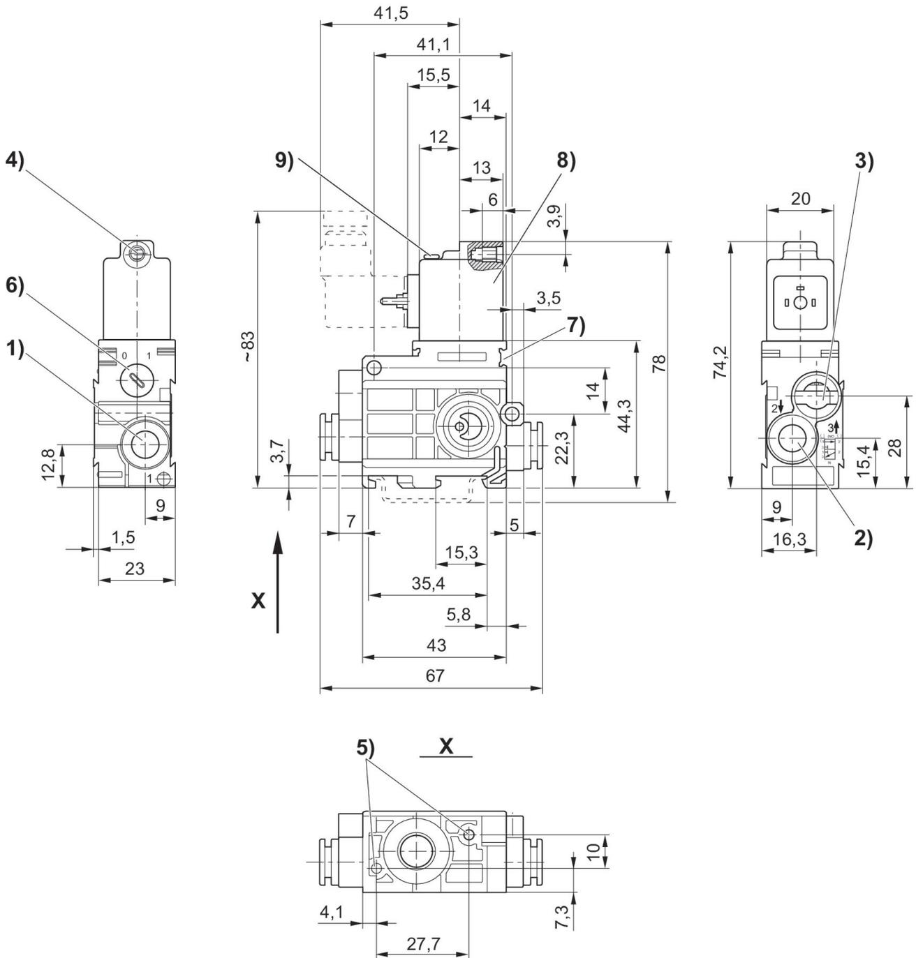
1) Anschluss 1 2) Anschluss 2 3) Anschluss 3, Abluft darf nicht gedrosselt werden 4) Kern-Ø für M5 5) Sackloch 6 tief für Blechschraube 3,5 6) Handhilfsbetätigung 7) Befestigungsmöglichkeit für Bezeichnungsschild 8) Spule um 180° drehbar 9) LED
