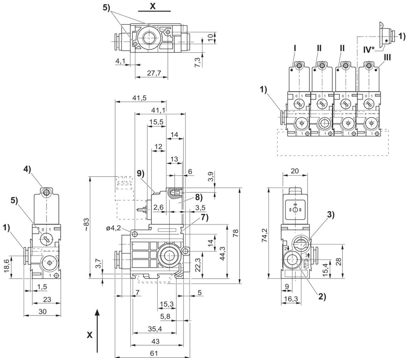
1) Anschluss 1 2) Anschluss 2 3) Anschluss 3, Abluft darf nicht gedrosselt werden 4) Kern-Ø für M5 5) Handhilfsbetätigung 6) Sackloch 6 tief für Blechschraube 3,5 7) Befestigungsmöglichkeit für Bezeichnungsschild 8) Spule um 180° drehbar 9) LED \* Luft-Anschlussmodul (Pos. IV) montiert an Verkettungsventil (Pos. II) erlaubt zusätzliche Lufteinspeisung von der rechten Seite. Endventil (Pos. III) entfällt.
