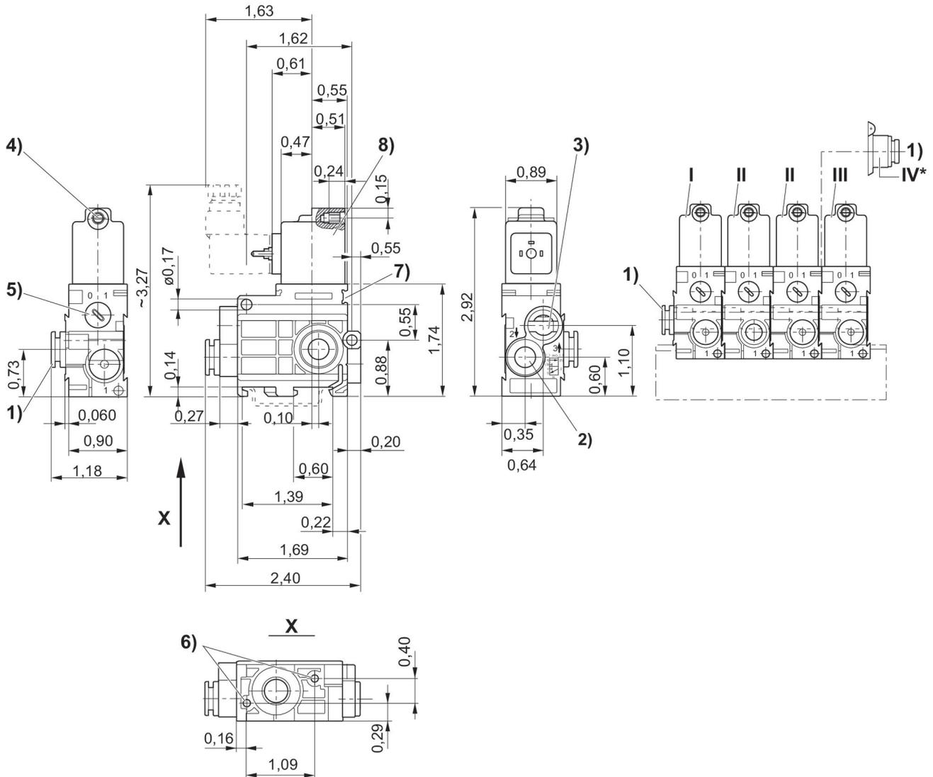
1) Conexão 1 2) Conexão 2 3) Conexão 3, o ar de saída não deve ser estrangulado 4) Ø perf. central para M5 5) Acionamento manual auxiliar 6) Furo cego profundidade 6 mm para parafuso auto-atarraxante com Ø 3,5 mm 7) Possibilidade de fixação de placa de identificação 8) Bobina giratória em 180° \* Módulo de conexão de ar (pos. IV) montado na válvula de encadeamento (pos. II) permite alimentação adicional de ar pelo lado direito. Válvula final (pos. III) desnecessária.
