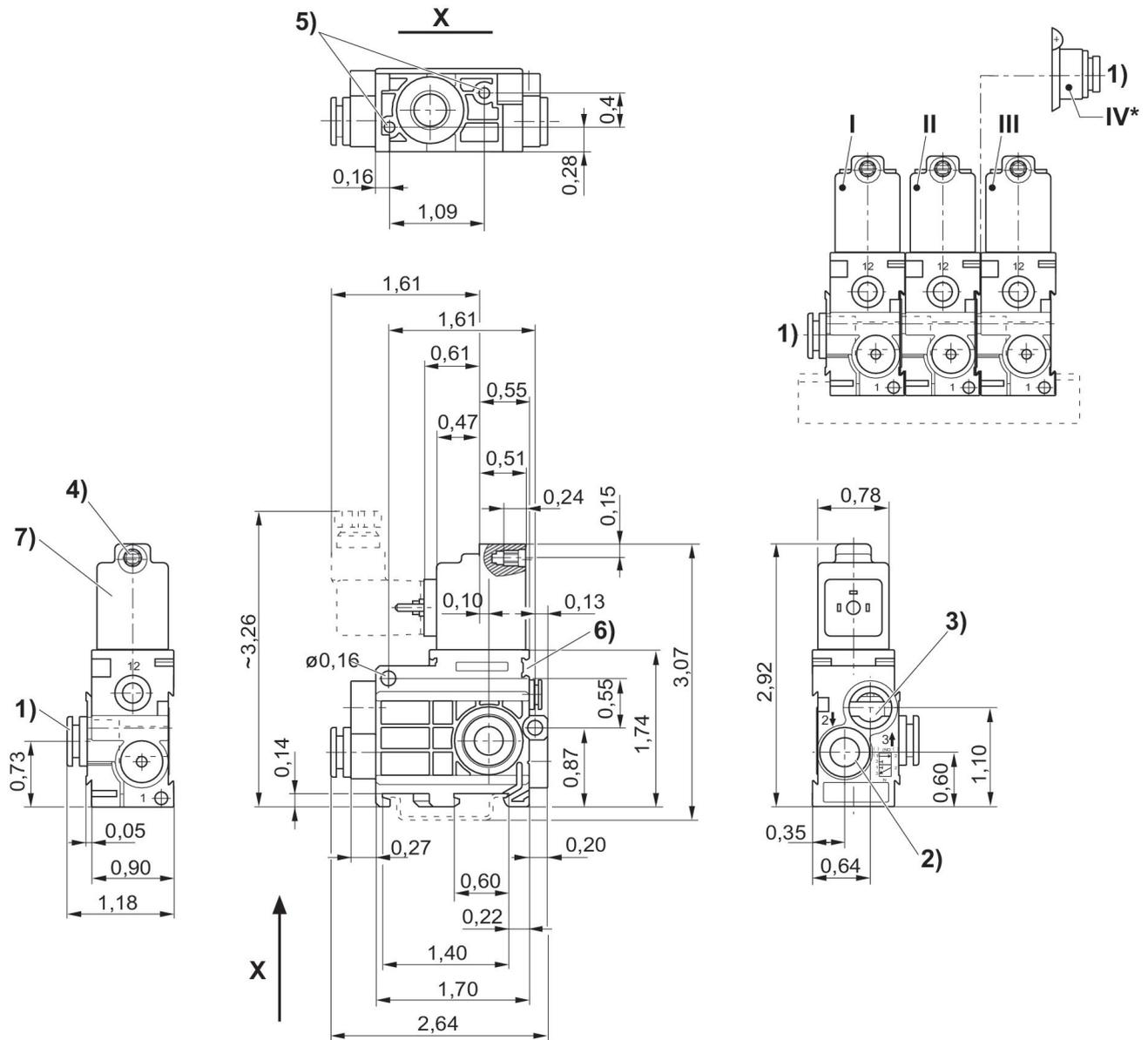
1) Conexión 1 2) Conexión 2 3) Conexión 3, no debe estrangularse el aire de escape 4) Ø del núcleo para M5 5) Agujero ciego de 6 mm de profundidad para tornillo para chapa con Ø 3,5 mm 6) Posibilidad de fijación para rótulo indicador 7) Bobina giratoria 180° 8) Conexión 12 \* El módulo de conexión de aire (pos. IV) montado en la válvula de concatenación (pos. II) permite una alimentación adicional de aire del lado derecho. La válvula final (pos. III) desaparece.
