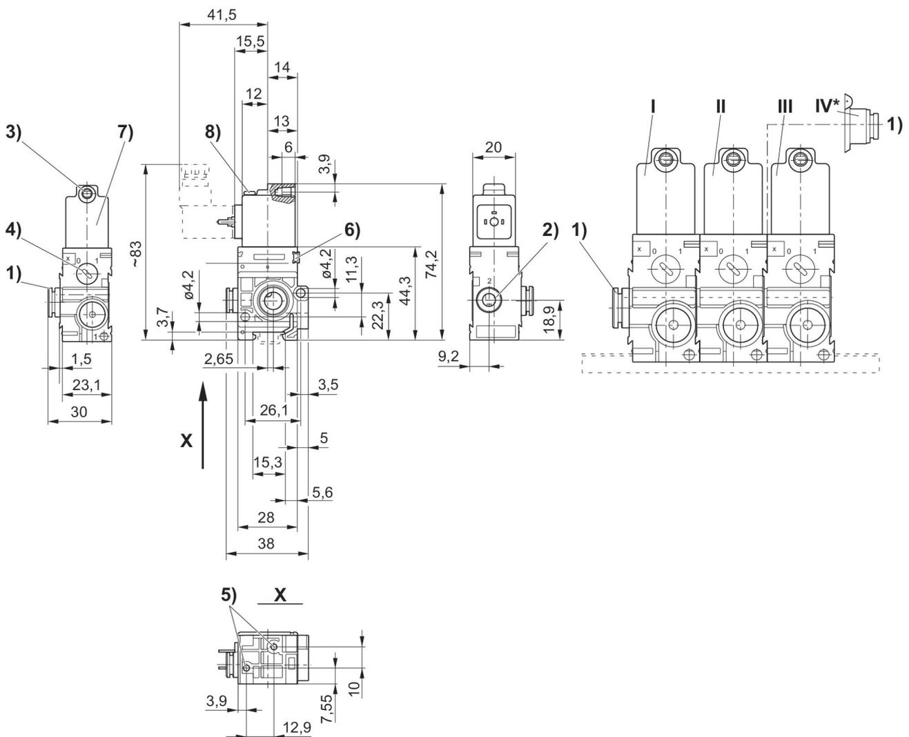
1) Attacco 1 2) Attacco 2 3) Attacco 3 Ø centrale per M5 4) Azionamento manuale 5) Foro cieco profondità 6 per vite autofilettante 3,5 6) Possibilità di fissaggio per targhetta 7) Bobina orientabile di 180° 8) LED \* Il modulo di collegamento pneumatico (pos. IV) montato sulla valvola per collegamento in batteria (pos. II) consente un'ulteriore alimentazione dell'aria dal lato destro. La valvola terminale non è più necessaria (pos. III).
