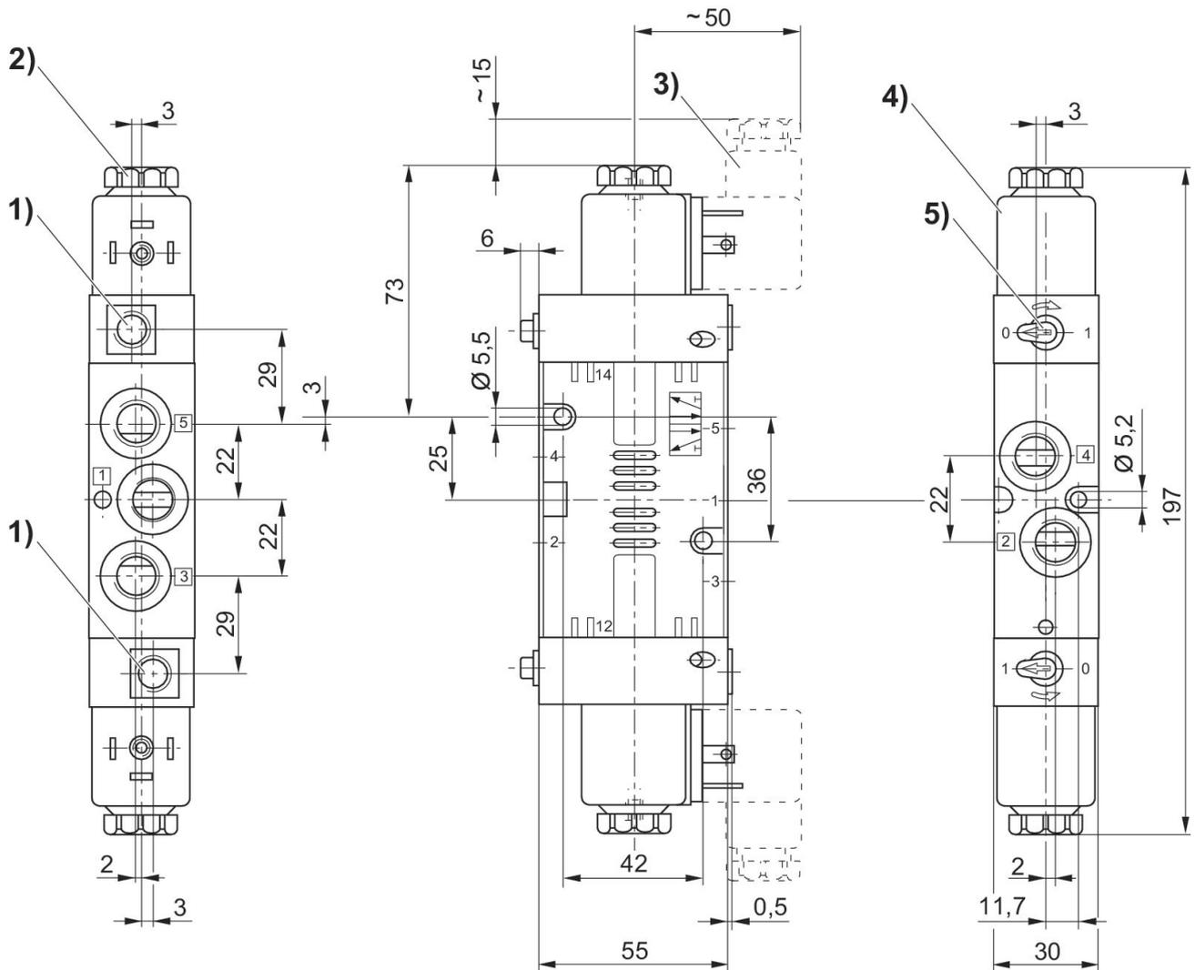
1) Nur bei separater Vorsteuerung G 1/8 2) nach Entfernen der Kappe Innengewinde M5 3) Ventilsteckverbinder 4) Spule jeweils um 45° steckbar 5) Handhilfsbetätigung
