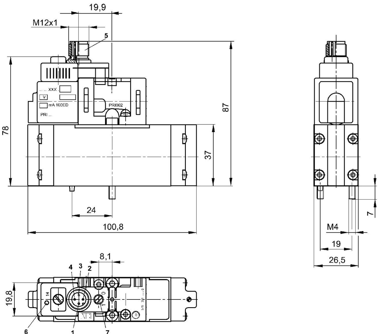
1) non occupato 2) non occupato 3) 0 V 4) magneti 14 5) connettore circolare metallico M12x1 6) LED giallo stato commutazione valvola 7) azionamento manuale
