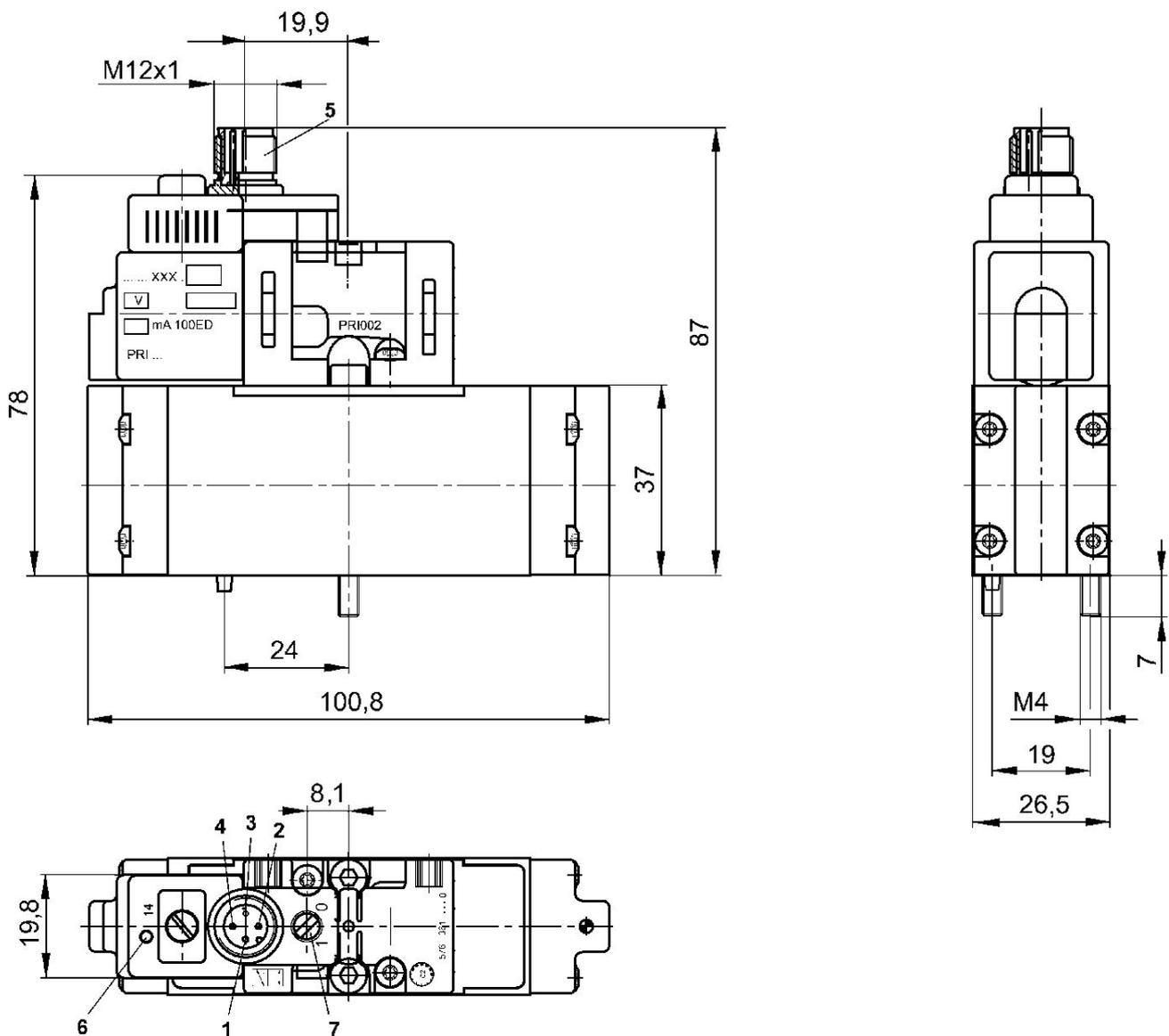
1) nicht belegt 2) nicht belegt 3) 0 V 4) Magnet 14 5) Metallischer Rundstecker M12x1 6) LED gelb Schaltzustand Ventil 7) Handhilfsbetätigung
