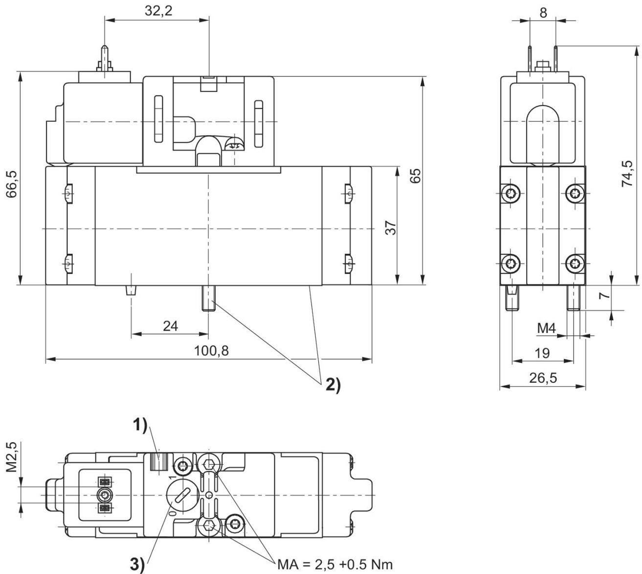
1) Possibilité de fixation de l'étiquette de repérage 2) Vis et joints imperdables 3) Commande manuelle auxiliaire
