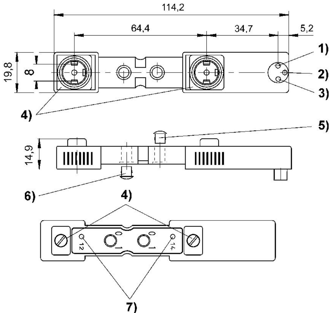
1) ímã 14 2) ímã 12 3) 0 V 4) vedação e parafuso com proteção contra perda 5) capa de fechamento para acionamento manual auxiliar, não desmontável 6) desmontável 7) LED válvula
