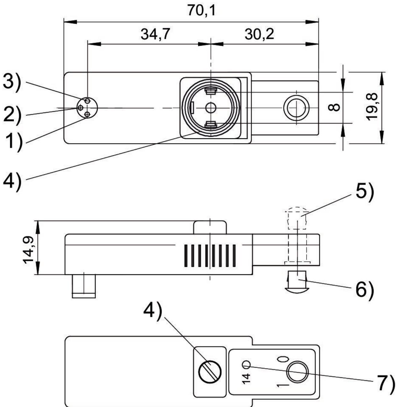
1) imán 14 2) no ocupado 3) 0 V 4) junta y tornillo a prueba de pérdida 5) tapón de cierre para accionamiento auxiliar manual, no desmontable 6) desmontable 7) LED válvula
