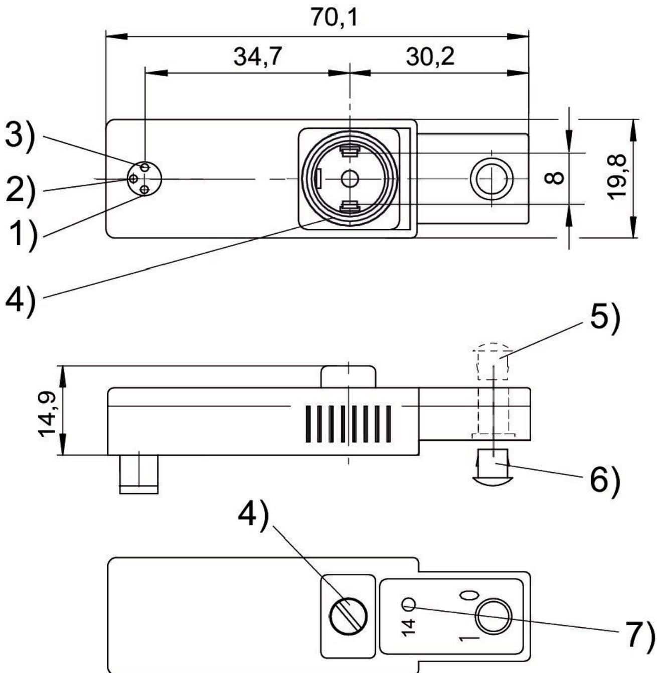
1) imã 2) não ocupado 3) 0 V 4) vedação e parafuso com proteção contra perda 5) capa de fechamento para acionamento manual auxiliar, não desmontável 6) desmontável 7) LED válvula
