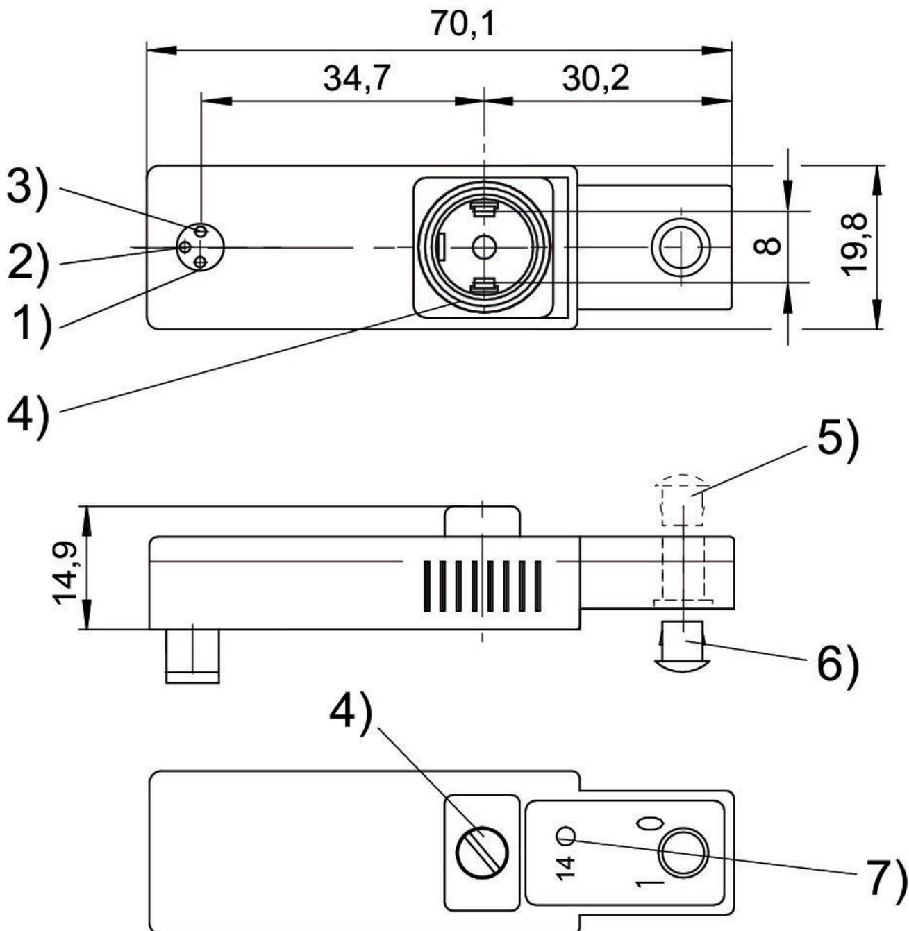
1) Aimant 14##2) Non affecté##3) 0 V## 4) Joint et vis avec protection contre la perte##5) Bouchon d'étanchéification pour la commande manuelle auxiliaire, non démontable##6) Démontable##7) DEL du distributeur
