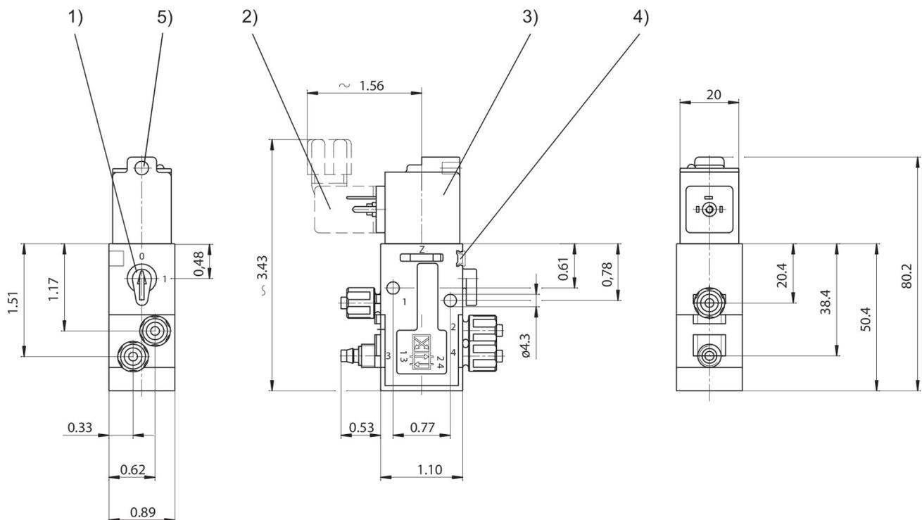
1) Handhilfsbetätigung 2) Ventilsteckverbinder 3) Spule ist um 180° drehbar 4) Befestigungsmöglichkeit für Bezeichnungsschild 5) Bohrung für M5-Verschraubung oder Schalldämpfer Ø 4,5 mm
