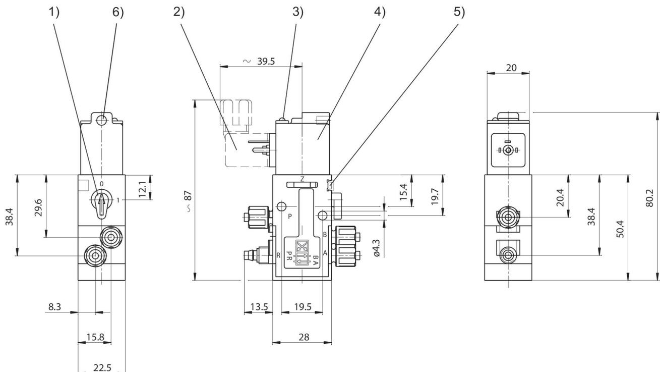
1) Hand Hilfsbetätigung 2) Ventilsteckverbinder 3) LED-Anzeige 4) Spule ist um 180° drehbar 5) Befestigungsmöglichkeit für Bezeichnungsschild 6) Bohrung für M5-Verschraubung oder Schalldämpfer Ø 4,5 mm
