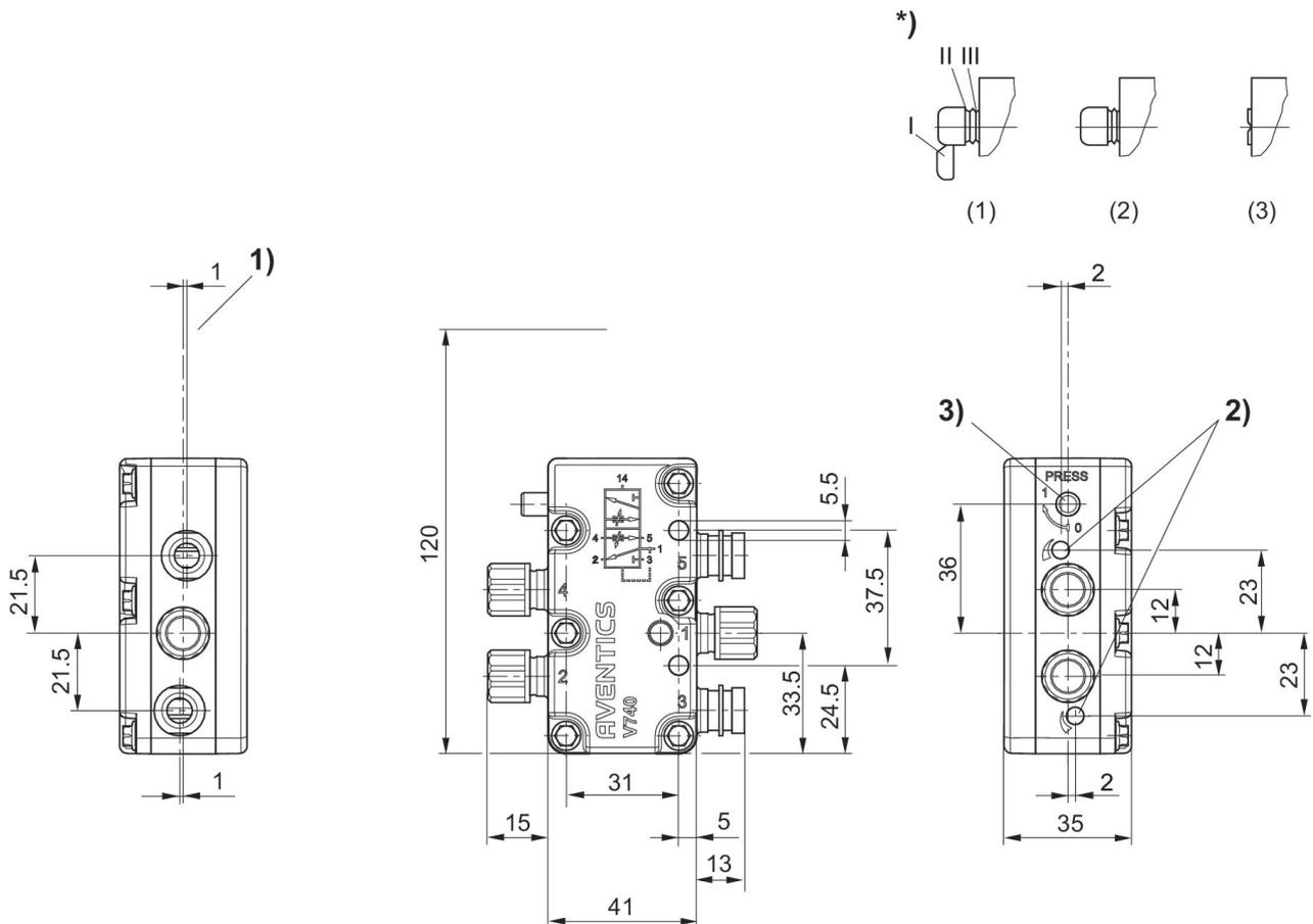
3) Accionamiento auxiliar manual e indicación de posición
