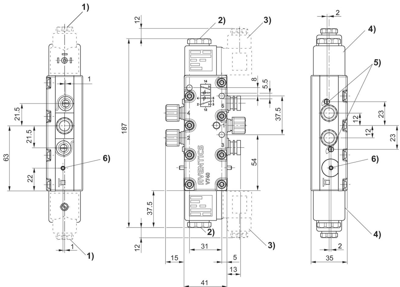
1) raccordo a premistoppa M16x1,5 2) filettatura interna M5 accessibile sotto il tappo 3) connettore ruotabile ogni volta di 90° 4) bobina inseribile ogni volta di 45° 5) vite di strozzamento per gli scarichi 5 (R) e 3 (S) 6) azionamento manuale ed indicatore di posizione
