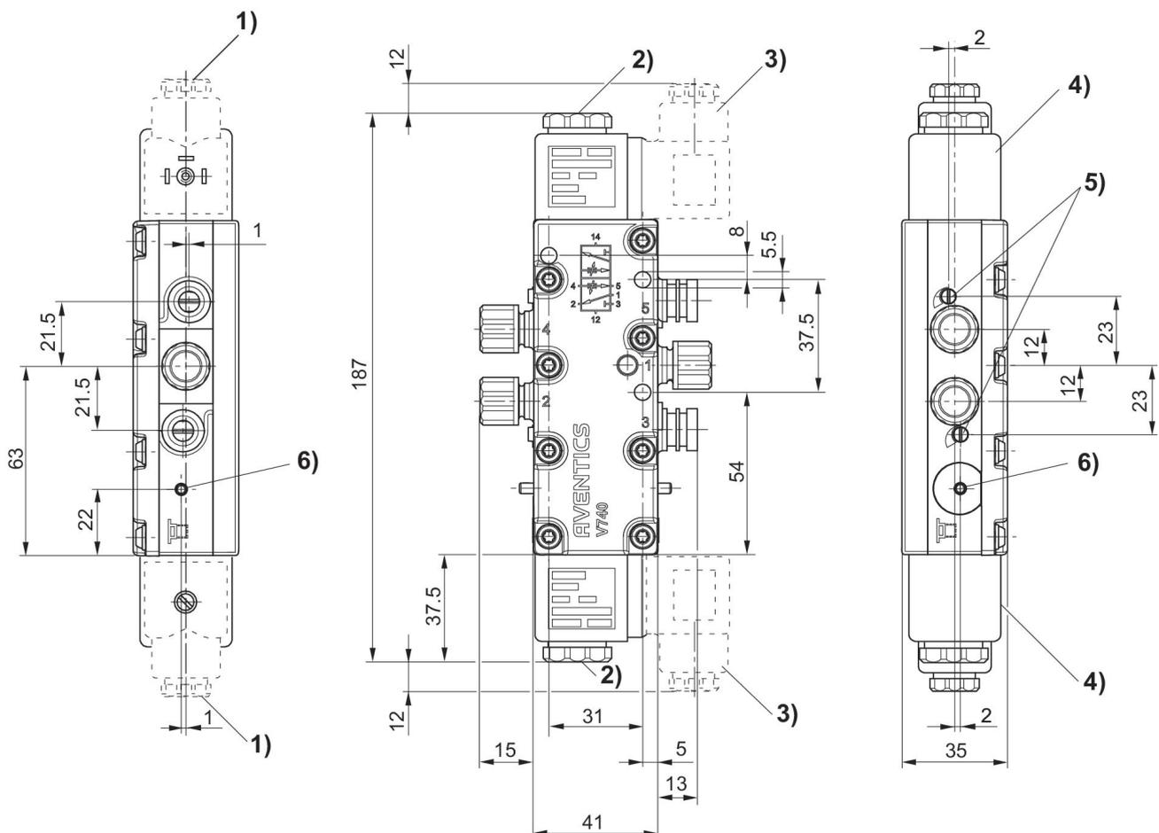
1) Raccord à presse-étoupe M16x1,5 2) Taroudage M5 accessible sous le capuchon 3) Connecteur orientable par pas de 90° 4) Bobine enfichable tous les 45° 5) Vis d'étranglement des échappements 5 (R) et 3 (S) 6) Commande manuelle et indicateur de position
