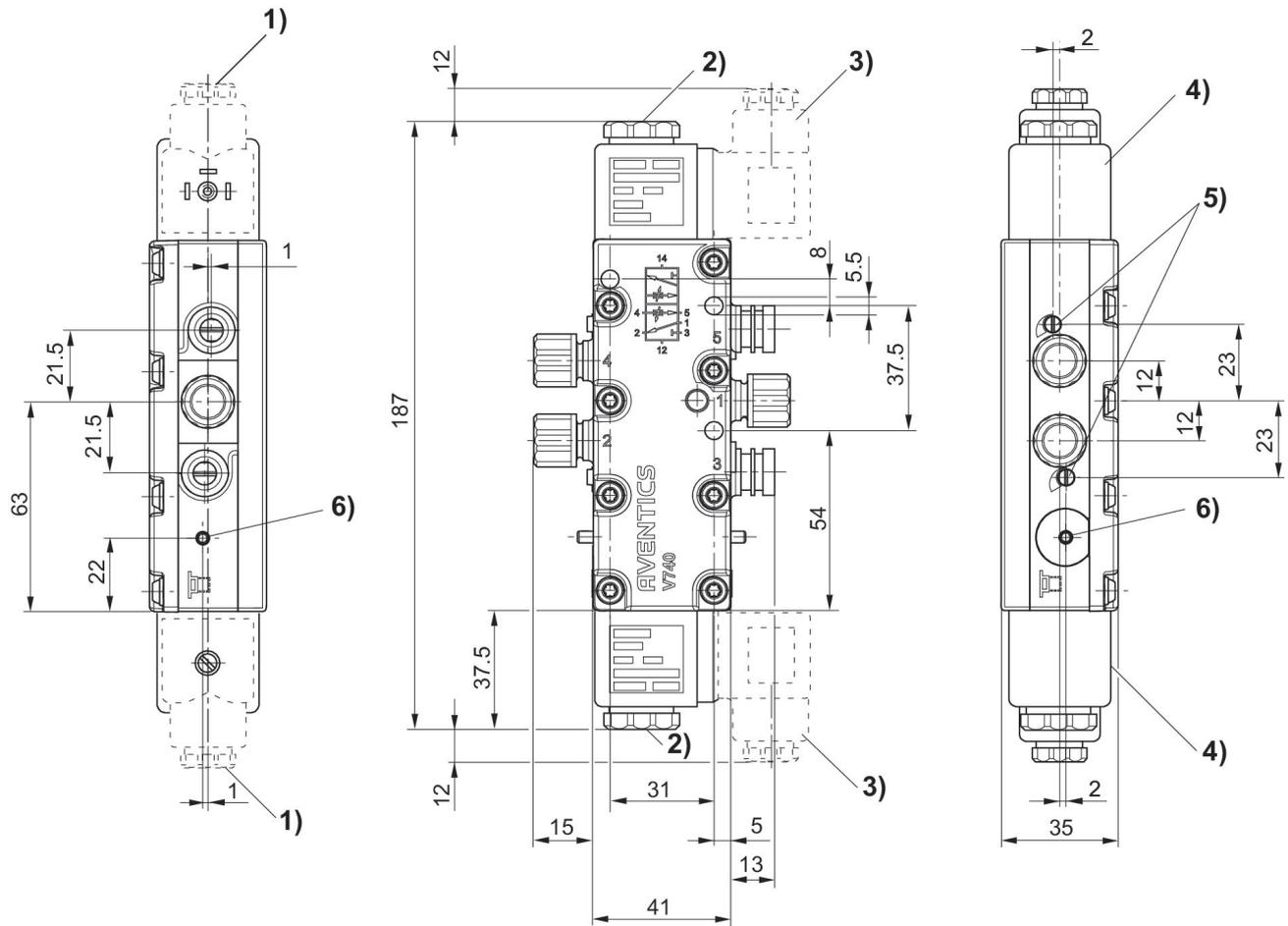
1) Stopfbuchsenschraubung M16x1,5 2) M5 Innengewinde unter Kappe zugänglich 3) El. Stecker kann bei 90° Intervallen fixiert werden 4) Spule kann befestigt werden bei 45° Intervallen 5) Manuelle Übersteuerung und Positionsindikator
