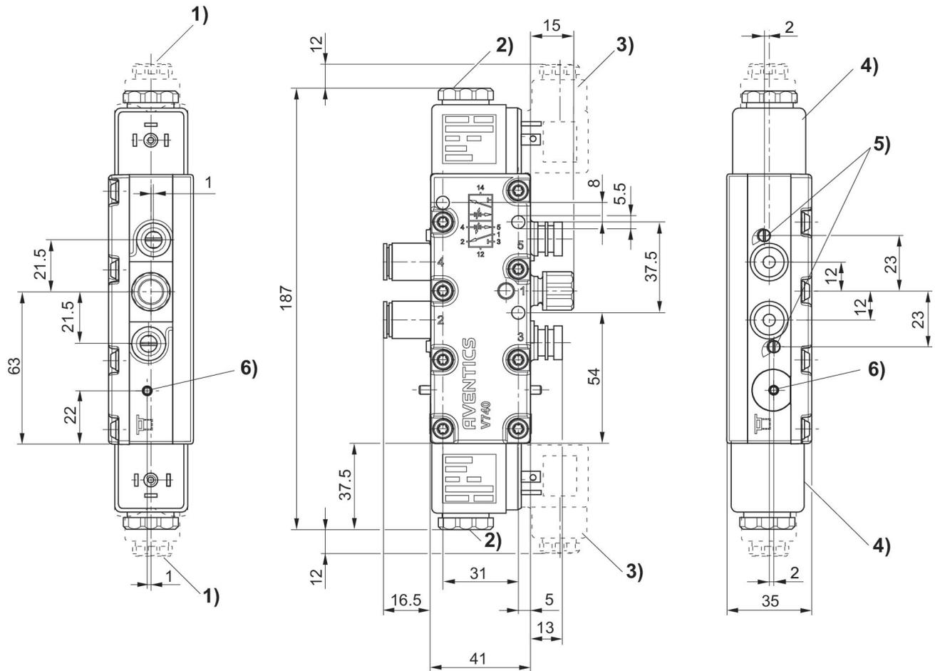
1) Stopfbuchsenschraubung M16x1,5 2) M5 Innengewinde unter Kappe zugänglich 3) Ventilsteckverbinder um jeweils 90° drehbar 4) Spule um jeweils 45° steckbar 5) Drosselschraube für die Entlüftungen 5 (R) und 3 (S) 6) Handhilfsbetätigung und Stellungsanzeige
