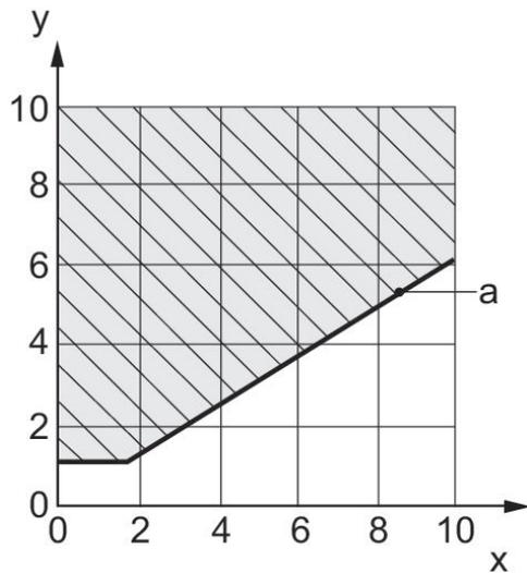
Diagramm für Steuerdruckbereich x: Betriebsdruck (bar) y: Steuerdruck (bar) a: minimaler Steuerdruck an Anschluss 14 (Z) in Abhängigkeit vom Betriebsdruck
