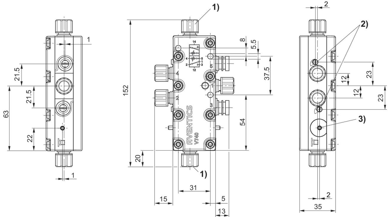
1) para tubo Ø 8 x 1 2) tornillo de estrangulación para escapes 5(R) y 3(S) 3) indicación de posición
