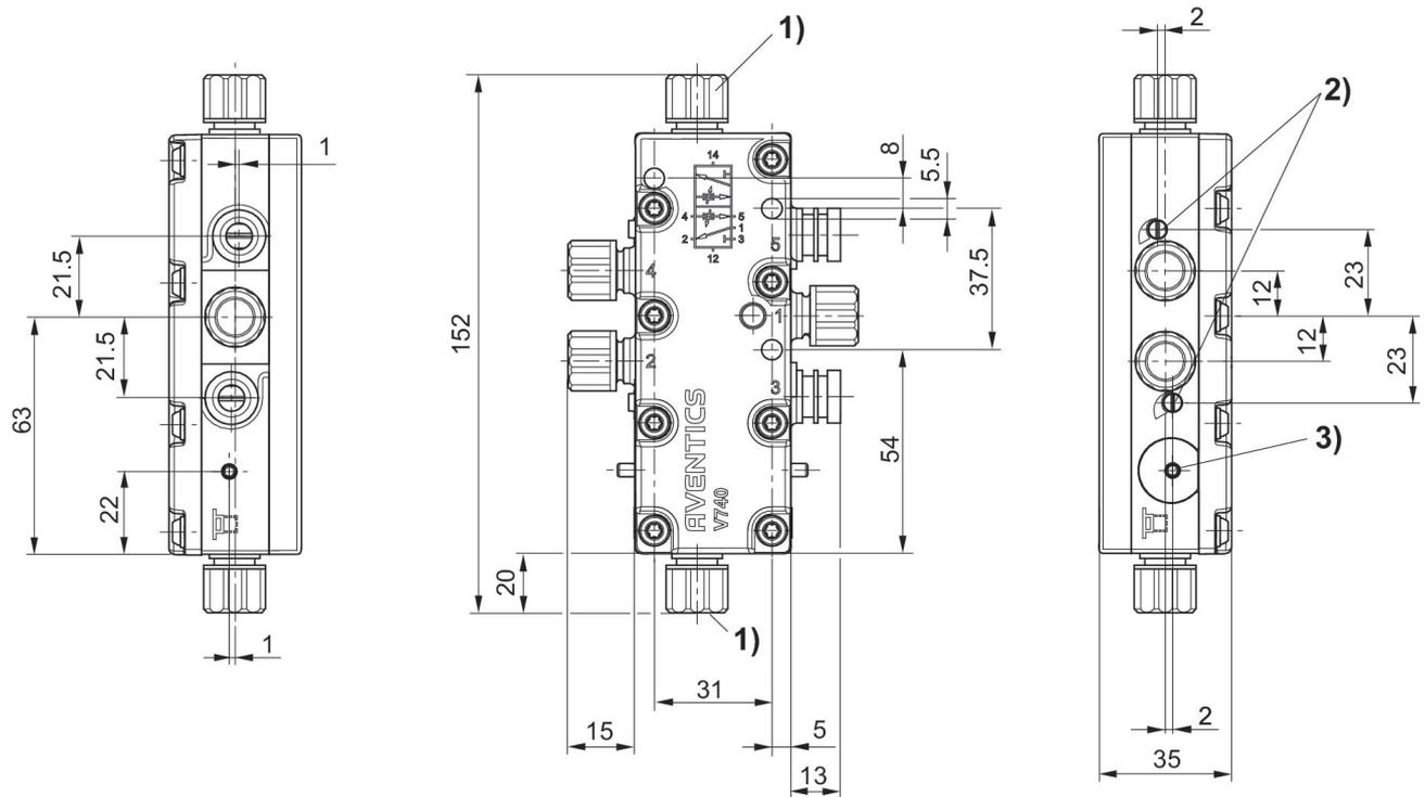
1)  $\varnothing 8 \times 1$  のチューブ用 2) 排気 5(R)と3(S)用絞りねじ 3) 調整表示
