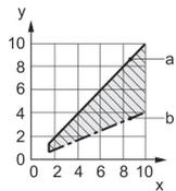
x: 作動圧力 (bar) y: 制御圧力 (bar) a: 作動圧力次第の最大制御圧力 b: 作動圧力次第の最小制御圧力
