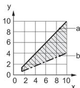
x : pression de service (bar) y : pression de commande (bar) a : pression de commande maximale en fonction de la pression de service b : pression de commande minimale en fonction de la pression de service
