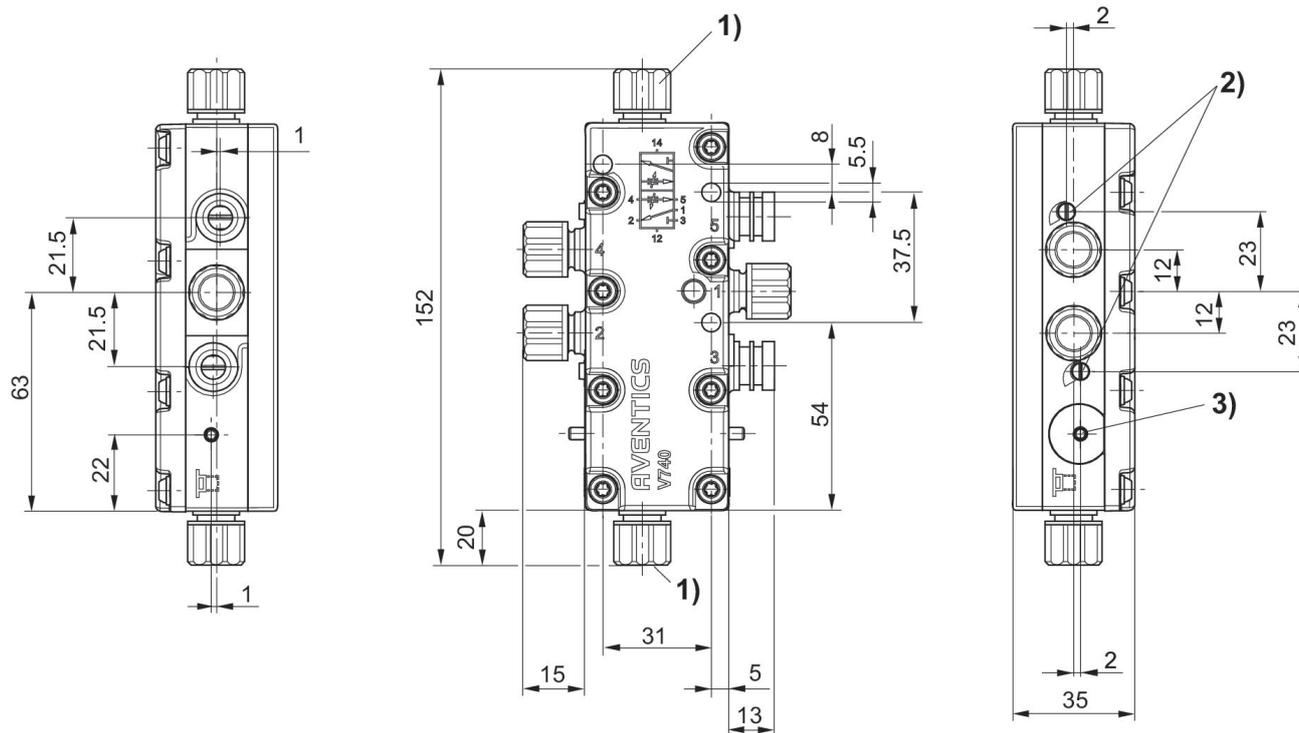
1) Pour tube  $\varnothing 8 \times 1$  2) Vis d'étranglement pour échappements 5(R) et 3(S) 3) Indicateur de position
