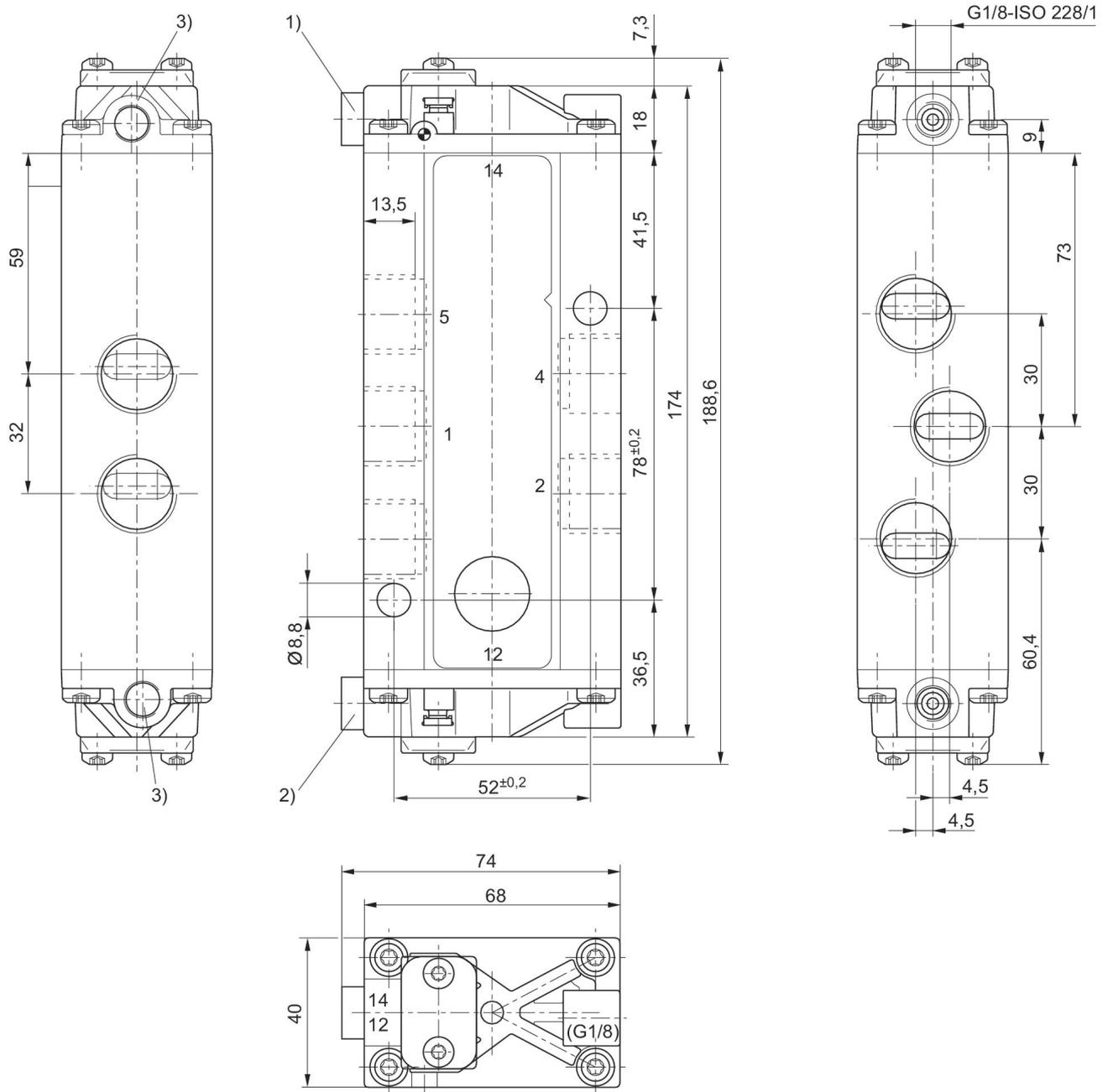
1) Conexión 14 2) Conexión 12 3) Conexión sin función
