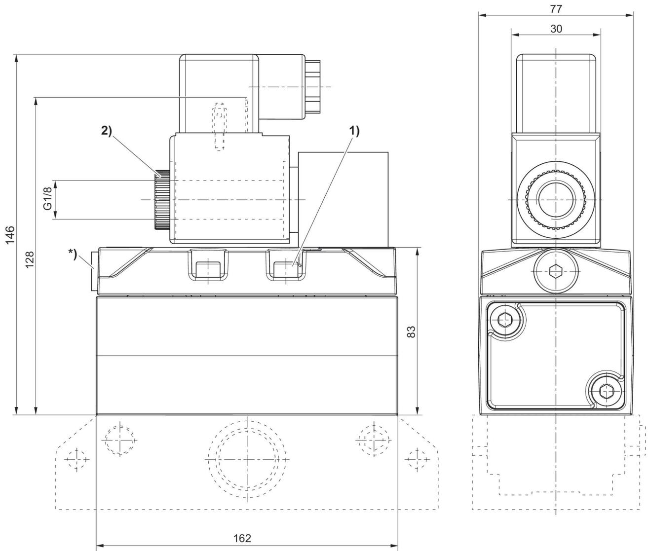
1) Couple de serrage des vis de fixation :  $2,2 \pm 0,2$  Nm
